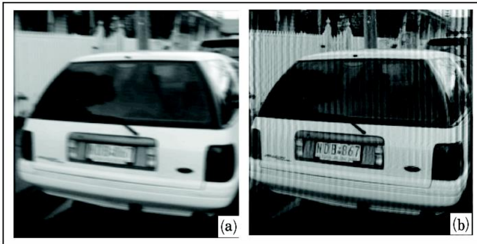
圖 1.3 去除影像模糊現象 (a) 原始影像 (b) 去除模糊現象結果
